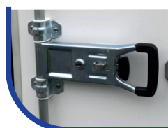
Doppelflügeltür hinten mit Drehstangenverschluss
